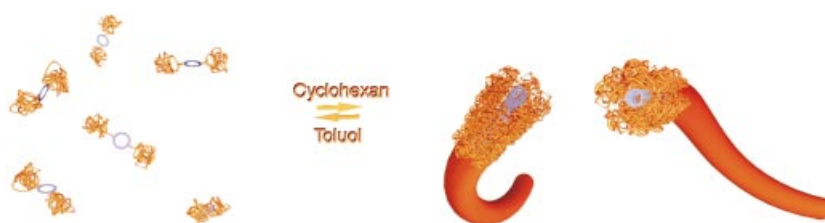
Abbildung 5. Schematische Darstellung der Aggregation der Blockcopolymere zu hohlen Polymerbürsten. Der PS-Block ist die Corona (orange), und der rigide Ring ist im Zentrum lokalisiert (blau) (nicht maßstabsgerecht).
